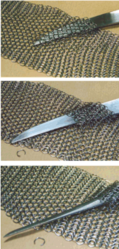
Bild 16: Intaktes Gewebe (oben) vorschriftsmäßiges Messer (siehe Tabelle 1) bei einem (!) fehlenden Ring (Mitte) extrem spitzes Messer (unzulässig) bei einem fehlenden Ring (unten)
