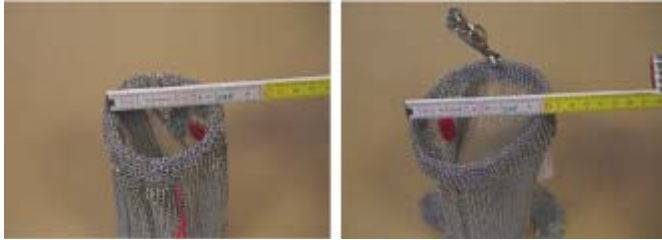
Bild 17: Federverschluss, links: geschlossen, rechts: geöffnet
