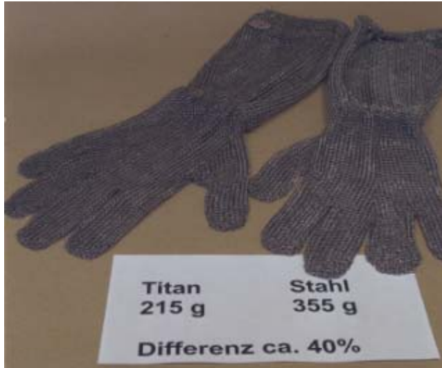
Bild 13: Vergleich von Titan mit Stahlringgeflechthandschuhen
