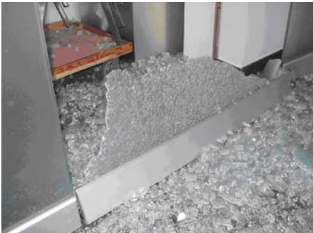
Abb. 1 Schollenbildung nach ESG-Bruch
