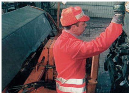
Einweisen zum Anbau eines Schneepfluges
