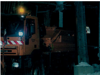
Beladen eines Winterdienstfahrzeugs aus einem Silo
