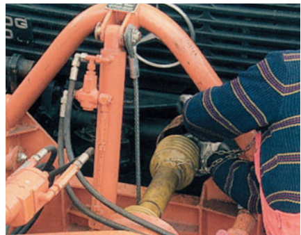
Zapfwellenanschluss einer Anbauschneeschleuder
