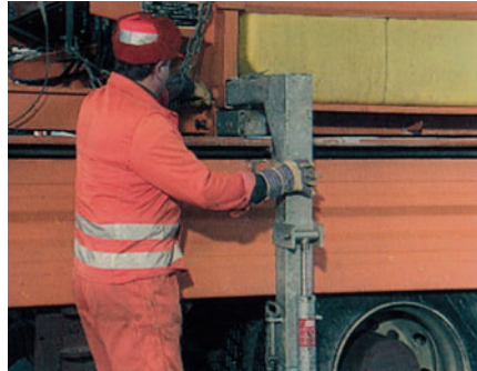
Entfernen der Stützen eines Streuautomaten
