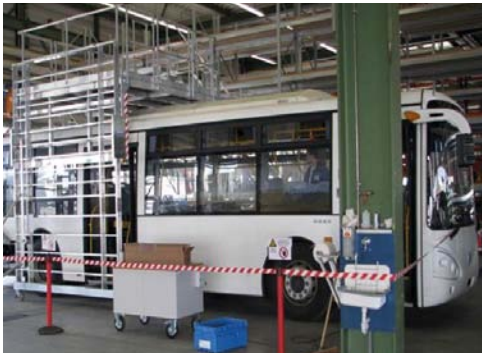
Bild 8: Beispiel für Absichern des Arbeitsbereichs bei Prüfarbeiten
