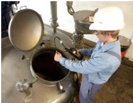
Abb. 19 Probenahme mittels Gasmessgerät
