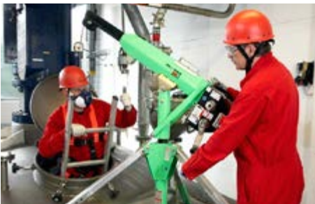
Abb. 22 Rettungswinde mit integrierter Absturz-sicherung
