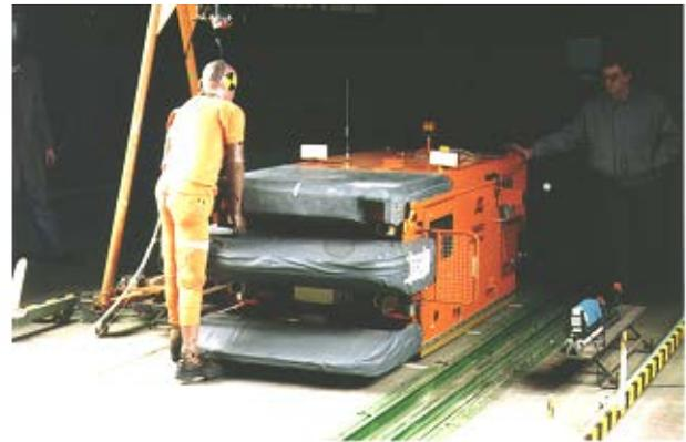
Kraftmessungen bei der Kollision eines fahrerlosen Flurförderzeugs mit dem Personendummy
