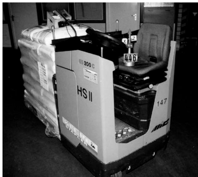
Niederhubwagen mit quer eingebautem Fahrersitz
