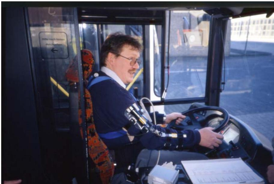
Technische Voraussetzung hierfür war ein elektromotorisch verstellbarer Fahrersitz, bei dem – im Gegensatz zu bereits auf dem Markt verfügbaren Fahrersitzen mit Speicherfunktion für Lkw und Pkw der gehobenen Preisklasse – die Daten auf einem externen Datenträger
