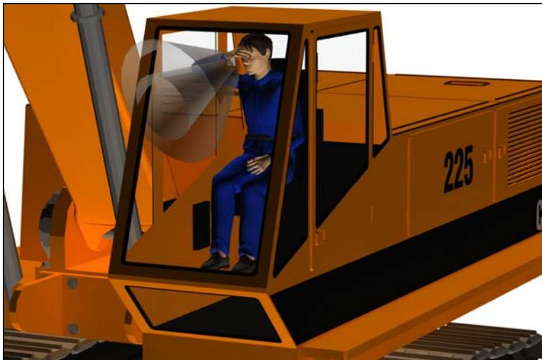
Mit unterschiedlich konfigurierten Menschmodellen können dann auf der Grundlage der ermittelten charakteristischen Körperhaltungsmodelle Sichtfeldanalysen erfolgen. Die gewonnenen Erkenntnisse sollen Ingenieure und Konstrukteure solcher Baumaschinen dabei unterstützen, die Auslegung der Kabine und des Baufahrzeugs so zu gestalten, dass erzwungene und ungünstige Körperhaltungen und Unfälle mit Personenschaden durch unzureichende Sicht minimiert werden.
