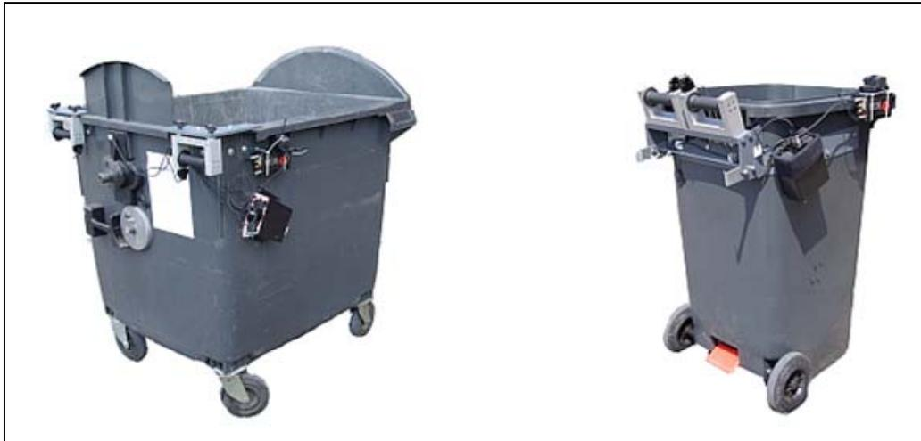
Mit dem CUELA-Messsystem (CUELA: Computer unterstützte Erfassung und Langzeit-Analyse von Belastungen des Muskel-Skelett-Systems) wurden Körperhaltungen, Gelenkwinkel der oberen und unteren Extremitäten und des Rückens sowie die Bodenreaktionskräfte während der Schiebe-, Zieh- und Manövriervorgänge aufgezeichnet [6]. Körperhaltungen und Handkräfte wurden kontinuierlich mit einer Abtastfrequenz von 50 Hz erfasst. Parallel wurden alle Versuche mit einer Videokamera dokumentiert.
