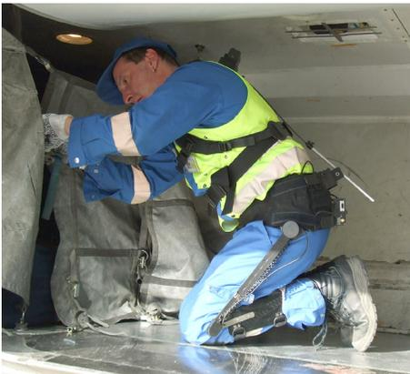
Neben der Körperwinkelbestimmung ist das Messsystem in der Lage, die Bodenreaktionskräfte durch in die Arbeitsschuhe eingelegten Druckmesssohlen aufzuzeichnen, wodurch die Höhe der gehandhabten Lastgewichte bestimmt werden kann [13]. Diese Option wurde bei der Belastungsmessung der Gepäckabfertiger genutzt. Bei den Flugzeugabfertiger wurden die Druckmesssohlen nicht eingesetzt, da bei der überwiegend
