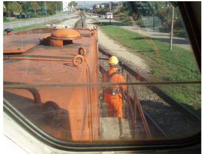
Rangierbetrieb: Fernsteuerung des Triebfahrzeugs vom Mitfahrerstand aus
