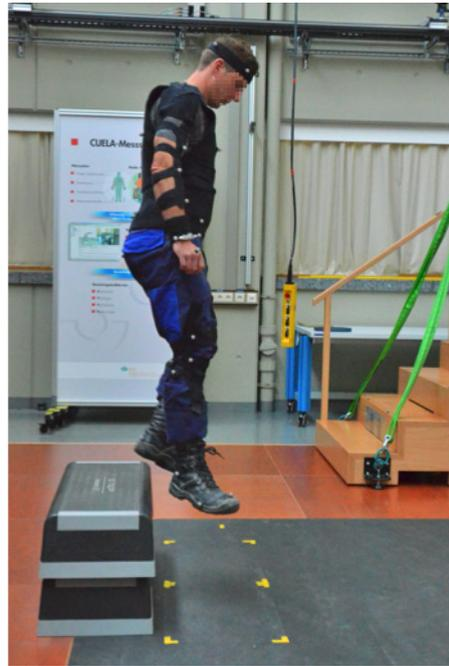
Das Versuchsdesign umfasste 18 unterschiedliche Einzeltätigkeiten, die wiederum in verschiedene Bewegungsphasen – wie Anheben und Absetzen eines Gewichts – eingeteilt wurden. Letztlich ergaben sich pro Proband über 30 Bewegungsphasen,
