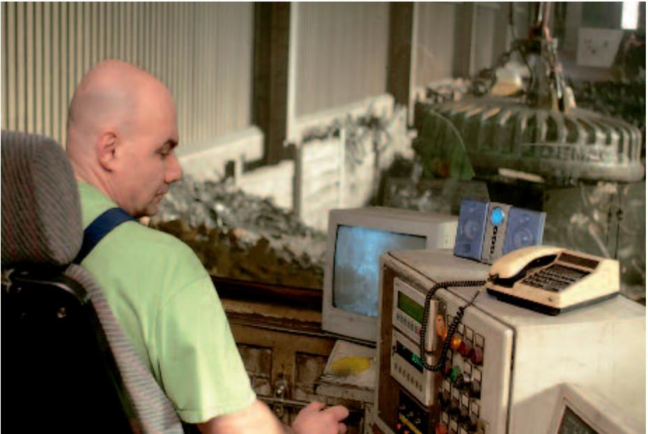
Im Schrott können sich geschlossene Hohlkörper und Sprengkörper verbergen, die nach dem Chargieren im Schmelzaggregat Brände und Explosionen mit erheblichem Schaden verursachen können. Öl- oder gasgefüllte Stoßdämpfer, Feuerlöscher, Gasflaschen oder geschlossene Rohrstücke sind hier beispielhaft zu nennen. Der Betrieb hat dafür zu sorgen, dass durch
