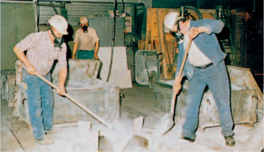
*Bild 12-4: Atemschutz bei der Kupolofenreparatur*
