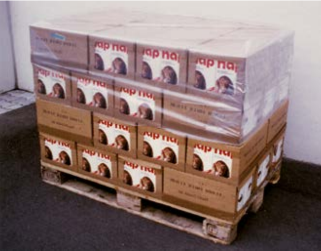
Abb. 9 Sicherung der oberen Lagen durch Kurzschrumpfhaube
