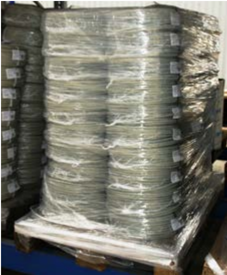
Abb. 16 Sicherung von Säulen aus Kabelrollen durch Stretchen
