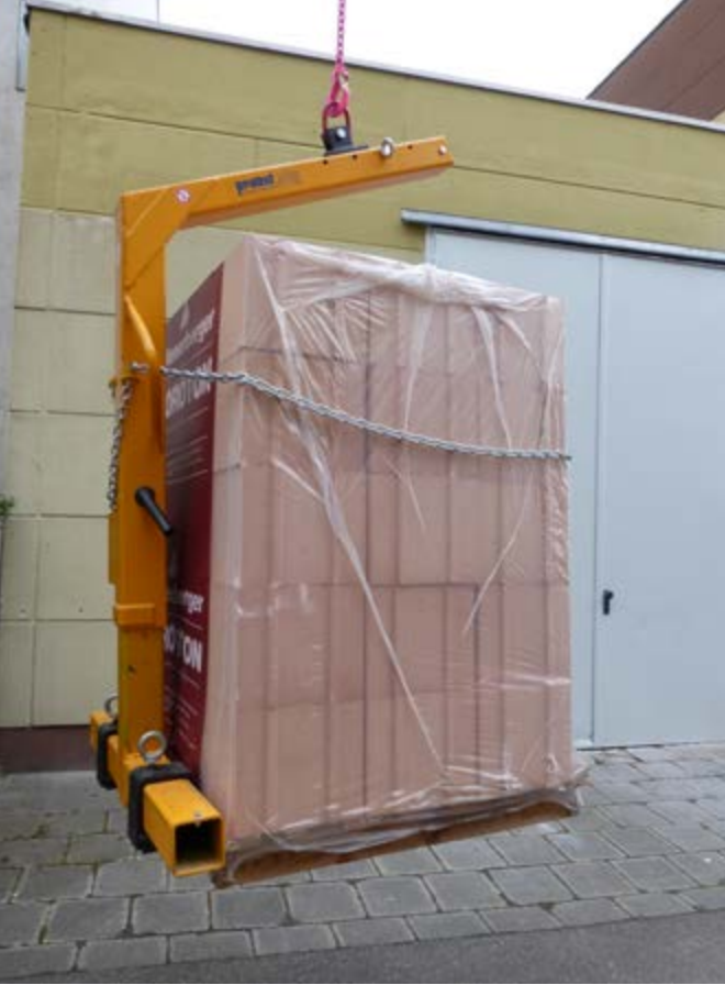
Abb. 18 Geschrumpftes Steinpaket auf Krangabel
