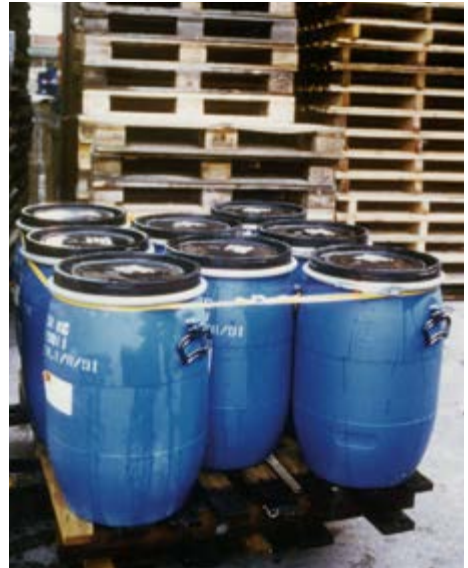
Abb. 13 Sicherung von Fässern durch Textilgurt mit Spannschloss
