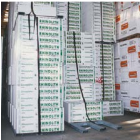
Abb. 20 Dämmplatten auf Spezialpaletten werden durch vertikal angebrachte Gummibänder gesichert
