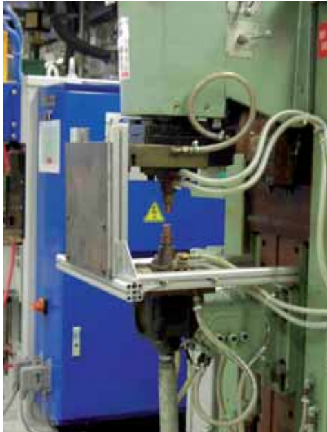
Bild 21a: Versuchsanordnung; vor dem Schweißfenster angebrachtes Schirmblech
