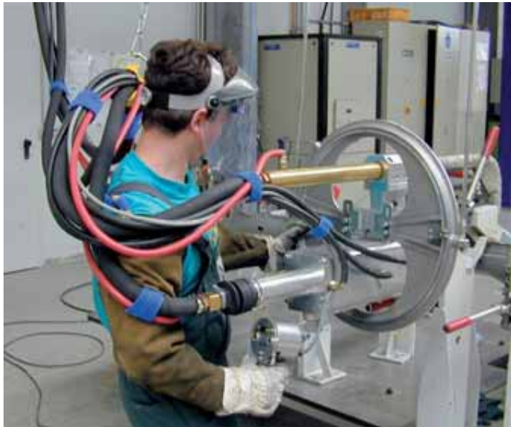
Bild 22: Beispiel für ungünstige Kabelführung
