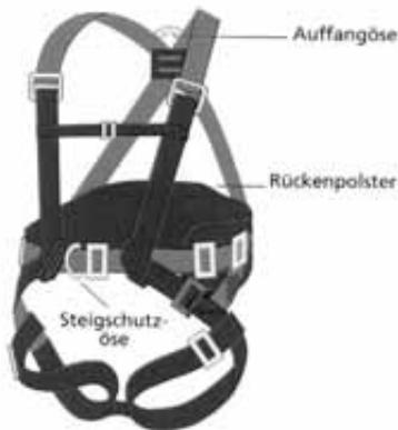
**Bild 3:** Auffanggurt mit rückseitiger Fangöse, und einer vorderen Steigschutzöse; Rückenstütze bzw. Rückenpolster ist vorhanden
