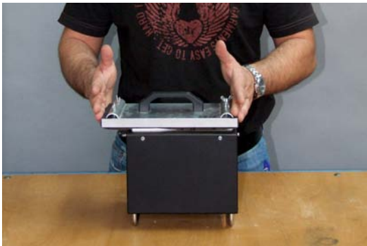
Bild 6: Anschleifen der Gleiter
