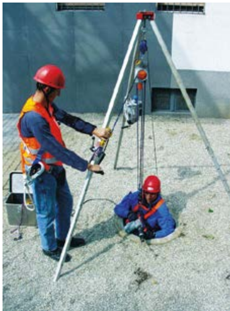
Abb. 27 Dreibock mit Rettungswinde
