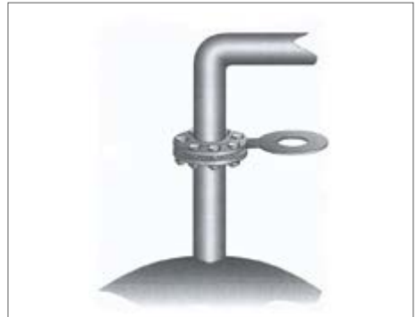
Abb. 18 Abtrennen mittels Steckscheibe
