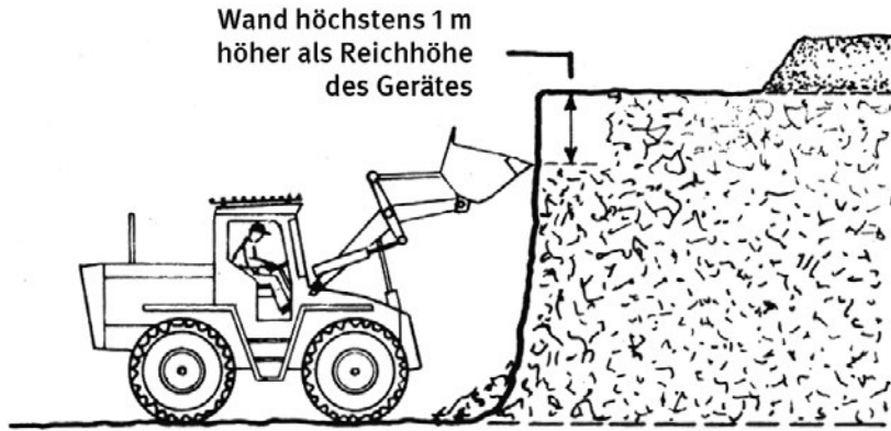
Bild 10: Gewinnung mit Schaufellader
