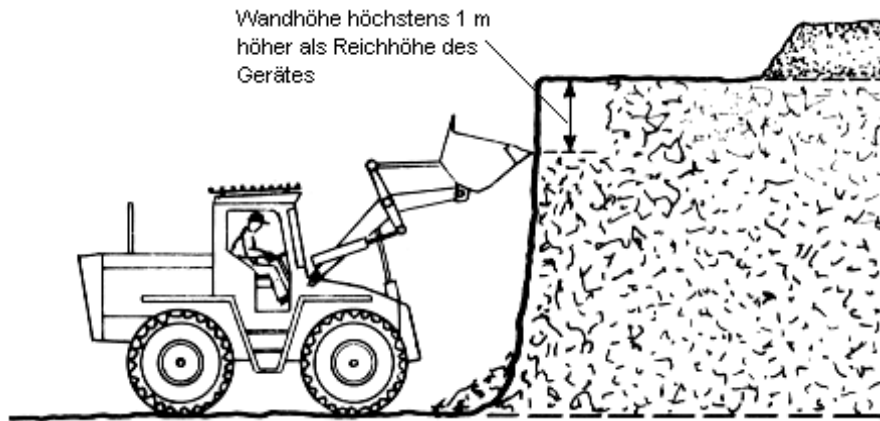
Bild 10: Gewinnung mit Schaufellader
