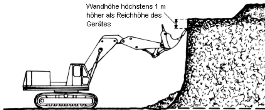
Bild 11: Gewinnung mit Hochlöffelbagger
