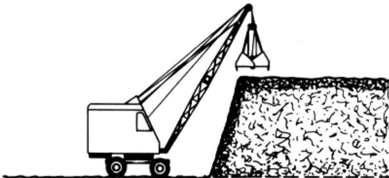
Bild 9: Gewinnung mit Greifbagger im Hochschnitt
