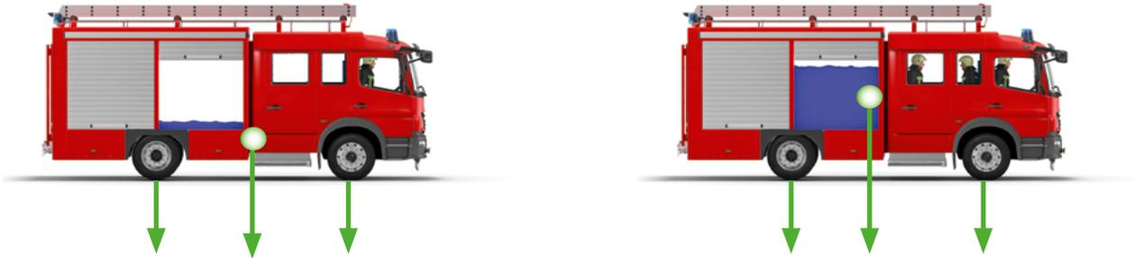
**Der Schwerpunkt liegt i. d. R. nicht genau in der Mitte, sondern dorthin verschoben, wo sich die schweren Bauteile, die Gerätschaften oder der Wassertank befinden. Der Schwerpunkt des leeren Fahrzeugs liegt anders als der des Beladenen.**
