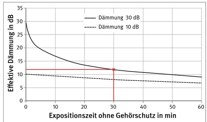
Abb. 13 Effektive Dämmung eines Gehörschützers mit 30 bzw. 10 dB Dämmung in Abhängigkeit von der Expositionszeit ohne Gehörschützer bezogen auf eine 8-Stunden-Schicht (Ausschnitt: Zeitraum 60 min)
