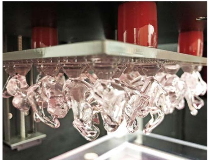
Abb. 32 3D-Drucke bei Entnahme aus dem Drucker
