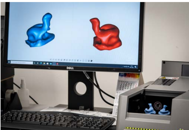
Abb. 30 Übertragung der gescannten Abformungen auf den PC
