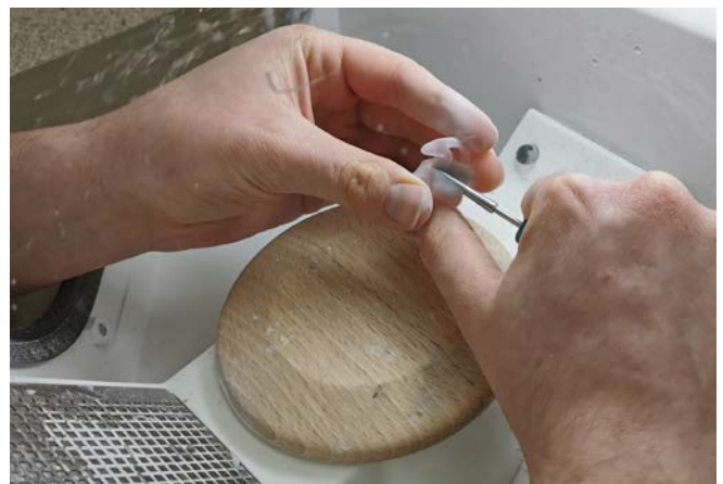
Abb. 33 Manuelle Nachbearbeitung der Otoplastiken
