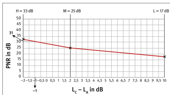
Abb. 14 Graphische Bestimmung der vorhergesagten Minderung des Geräuschpegels (PNR) nach HML-Methode
