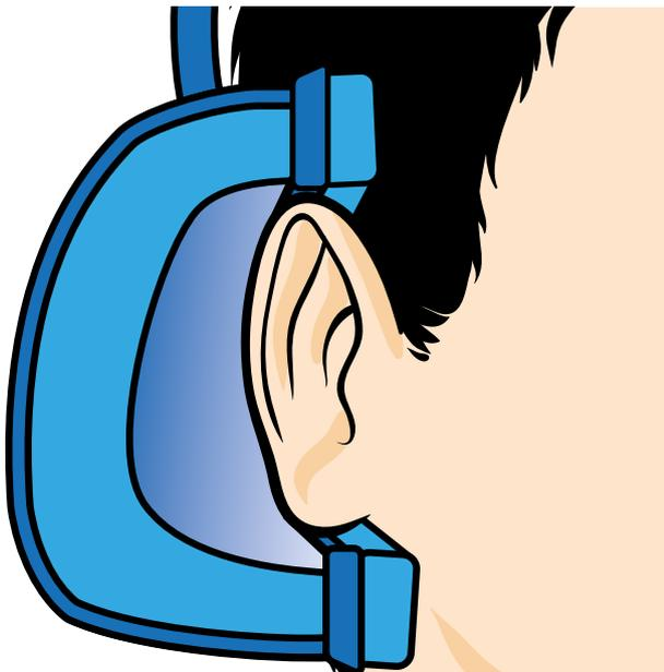
Abb. 2 Aufbau eines Kapselgehörschützers mit Kopfbügel
