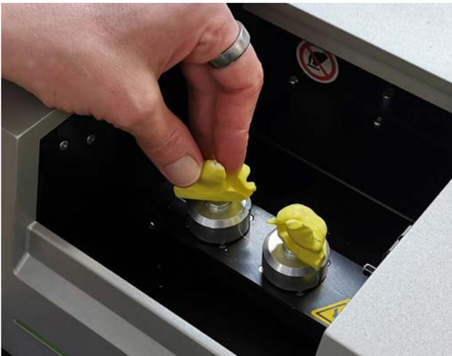
Abb. 29 Positionierung der Abformungen im Laserscanner
