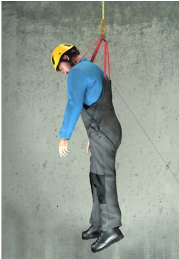
Abb. 10 Rettungsgurt in Arbeitshose eingearbeitet
