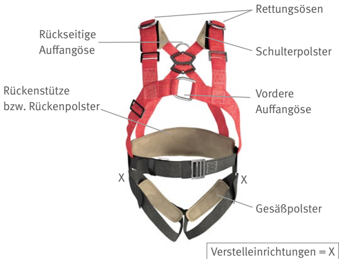
Abb. 9 Auffanggurt mit Rettungsösen
