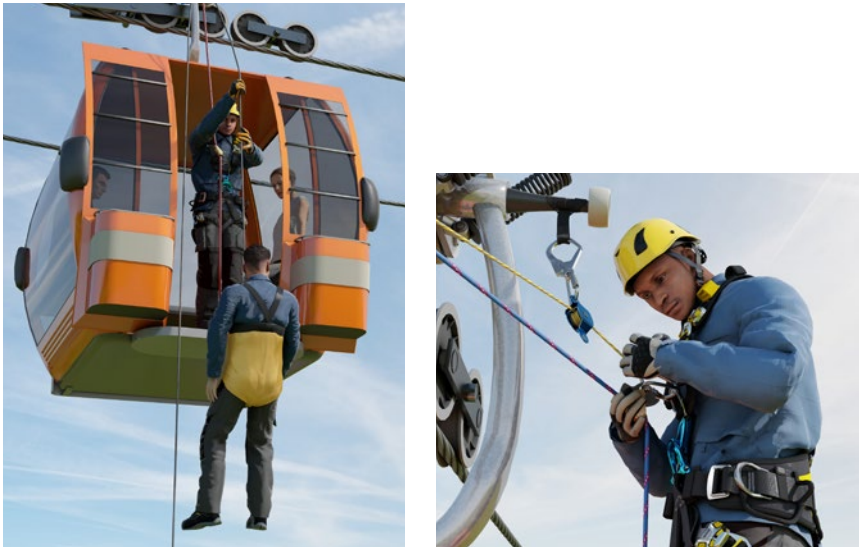
Abb. 7 Bergung aus einer Seilschwebbahn
