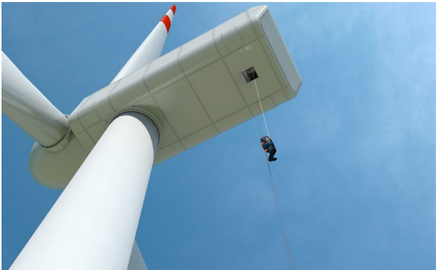
Abb. 8 Rettung aus dem Maschinenhaus
