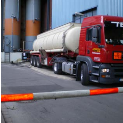
Abb. 12.4.1.1 Entladesituation mit LKW und Absperrung des Entladebereiches
