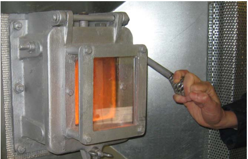
Abb. 10.3 Schauluke mit Sicherheitsverglasung
