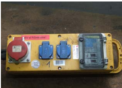
Abb. 9.2.3 Beispiel für einen Kleinvertei- ler mit Fehlerstromschutz- einrichtung zum Einsatz in leit- fähiger Umgebung. Eine Verwendung in leitfähigen Bereichen mit begrenzter Bewegungsfreiheit ist nicht zulässig.
