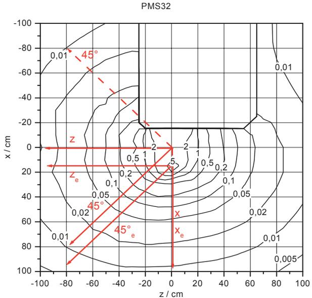
**Bild 2:** Gemessene Magnetflussdichte in der Umgebung einer Schweißmaschine (Größe des Schweißfensters 345 x 445 mm), horizontale Ebene in Höhe der Mitte des Schweißfensters, eingezeichnete Pfeile: im Katalog der Flussdichtewerte enthaltene Achsen
