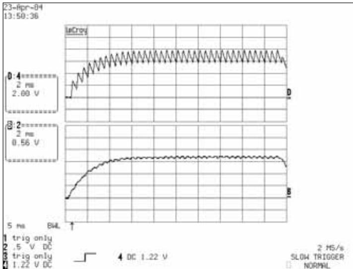
**Bild 7:** Strom- und Feldverlauf an einer Handschweißzange mit Inverterstromversorgung
