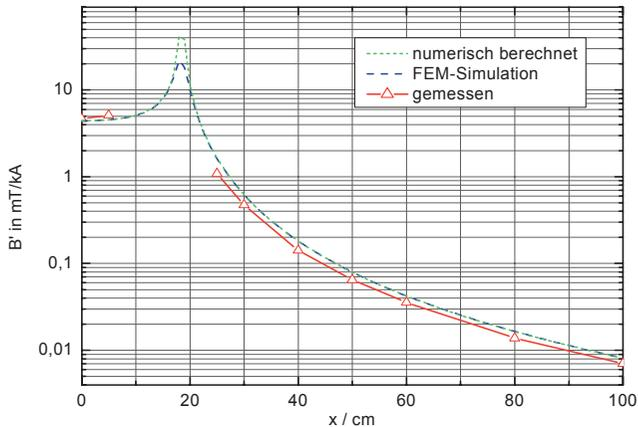
**Bild 5:** Stationäre Widerstandsschweißmaschine, Vergleich von Berechnung und Messung
