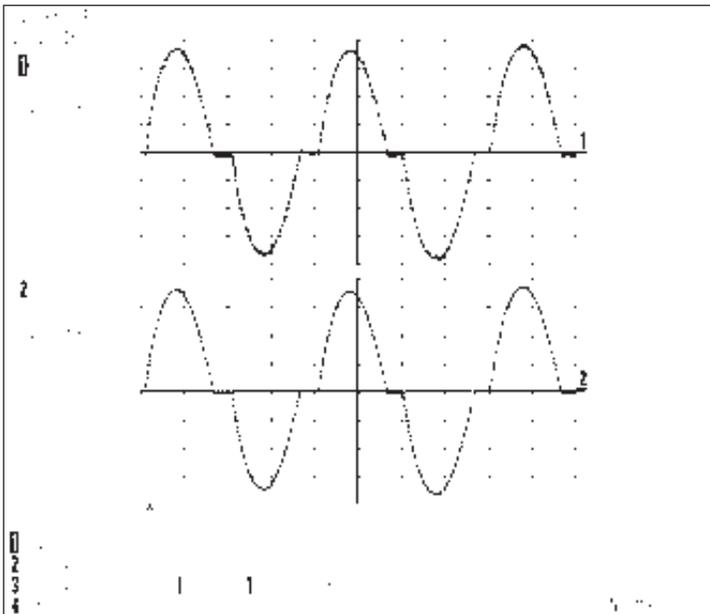
**Bild 13:** Messung mit Hochstrommessgerät (unten) und Schweißstrommessgerät (oben). Thyristorstromquelle, Schweißstrom  $25 \text{ kA}_{\text{eff}} / 38 \text{ kA}_{\text{pk}}$  (Messung im Kurzschluss)
