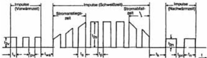
**Bild 1:** Prinzipieller Ablauf des Schweißvorganges
