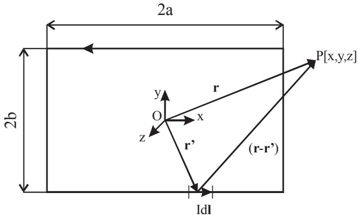
**Bild 6:** Bestimmung der magnetischen Flussdichte nach Biot-Savart
