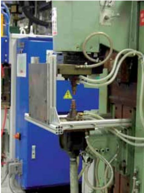
**Bild 21a:** Versuchsanordnung; vor dem Schweißfenster angebrachtes Schirmblech
