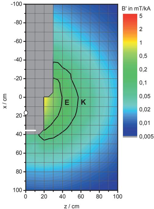
**Bild 21b:** Verteilung der Magnetflussdichte, Draufsicht auf horizontale Ebene durch die Mitte des Schweißfensters, eingetragene Abstandslinien für  $t_s = 200$  ms,  $I = 60 \text{ kA}_{\text{eff}}$  (für Bereich erhöhter Exposition): K – für Körper, E – für Extremitäten
