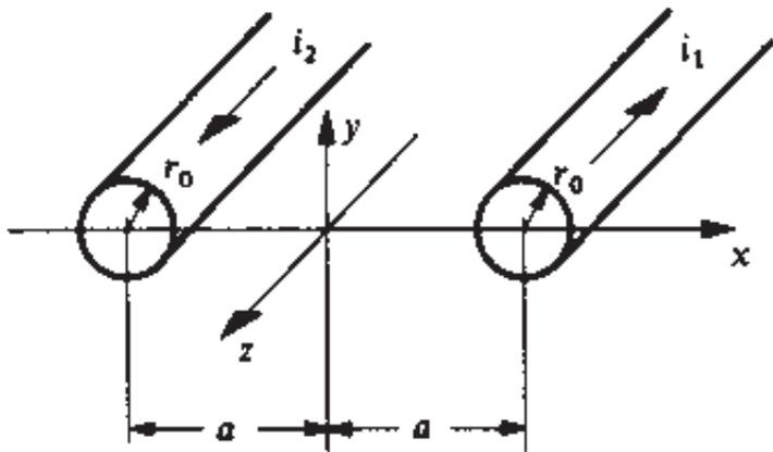
**Bild 1:** Schweißkabel (Doppelleitung)
