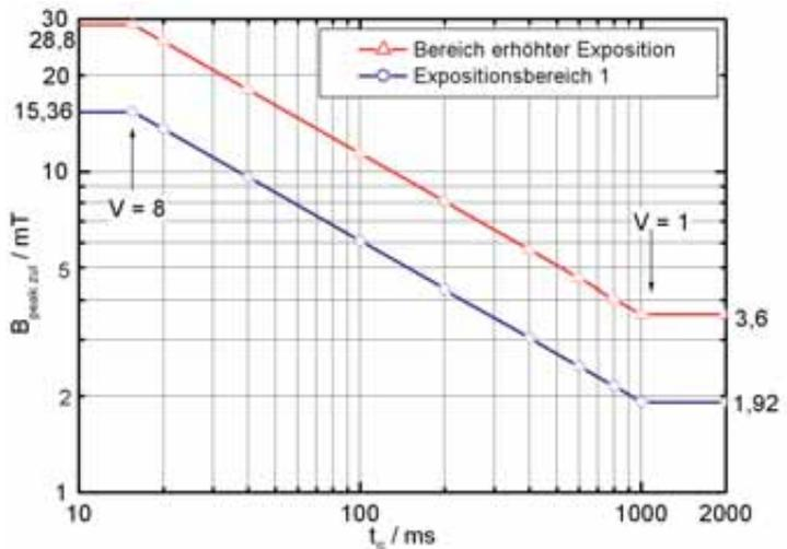
Bild 15: Zulassige Spitzenwerte der Flussdichte  $B_{peak\_zul}$  fur 50-Hz-Wechselstromschweieinrichtungen bei sinusformigem Strom
