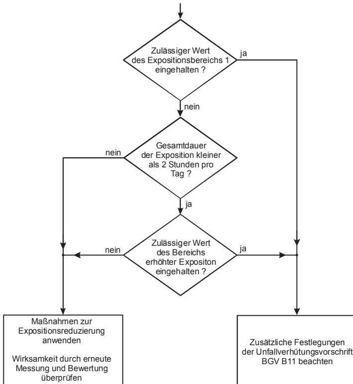
**Bild 14:** Flussdiagramm zum prinzipiellen Verlauf der Expositionsbeurteilung
