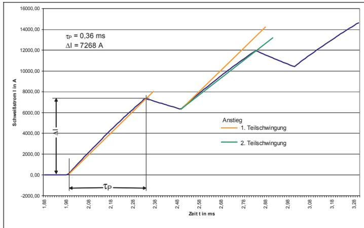
**Bild 10:** Bestimmung des frequenzbestimmenden zeitlichen Parameters  $\tau_p$
