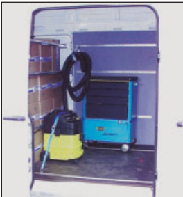
Abb. 20: Sicherung der Arbeitsmittel im Laderaum
