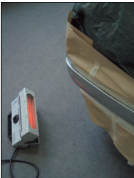
Abb. 17: Einsatz eines Infrarot-Flächentrockners
