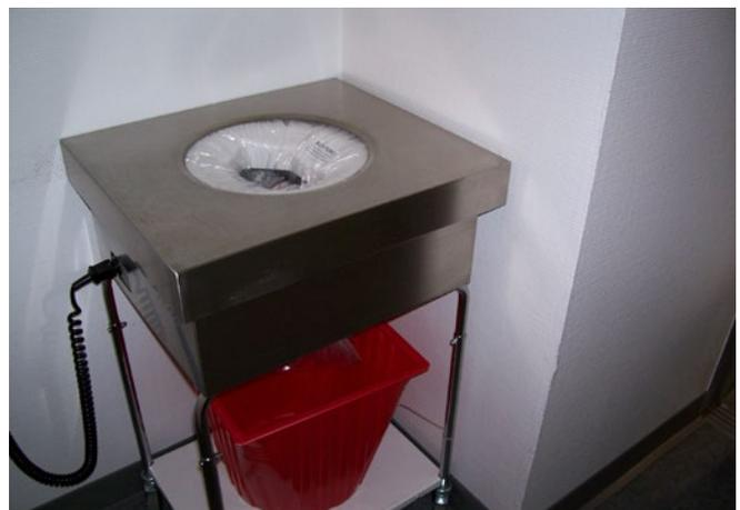
Abb. 15 Einschweißgerät für zytostatikahaltige Abfälle im Zubereitungsbereich
