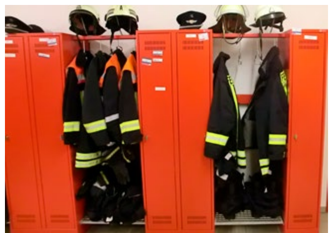
Bild 31 Spinde mit der Möglichkeit zur Schwarz-Weiß-Trennung durch Ablegen der PSA im offenen Teil und der privaten Sachen im Spindteil daneben
