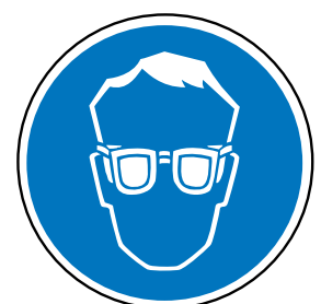
Bild 37 Hinweis auf eine erforderliche Schutzbrille
