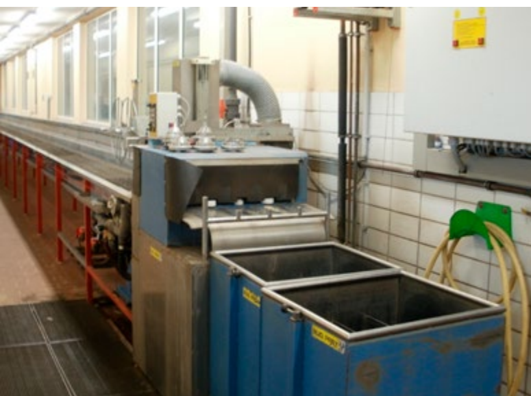
Bild 46 Fußboden mit Bodenablauf über begehbare Gitterrostfelder
