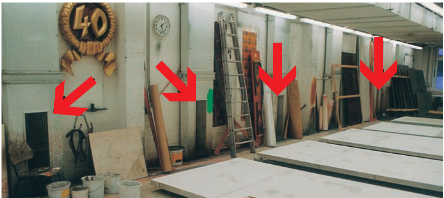
Abbildung 2: Randabsaugung im Wandbereich (siehe rote Pfeile) (Robrecht)
