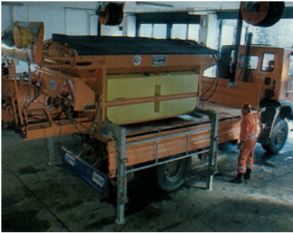
Aufbau eines Streuautomaten auf einen LKW
