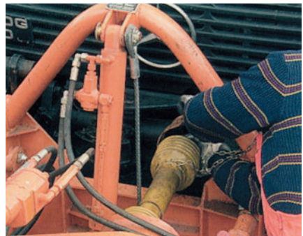
Zapfwellenanschluss einer Anbauschneeschleuder
