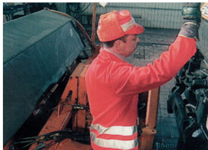
Einweisen zum Anbau eines Schneepfluges
