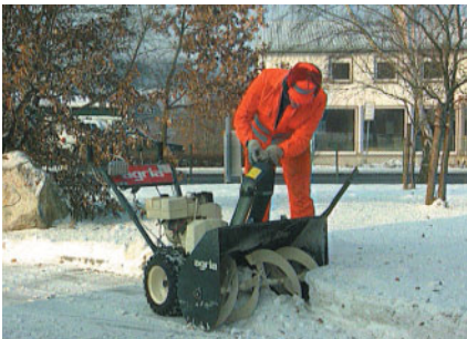
Einsatz des Stößels zum Beseitigen von Schneeverstopfungen
