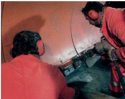
Auswechseln der Schürfleisten an einem Schneepflug
