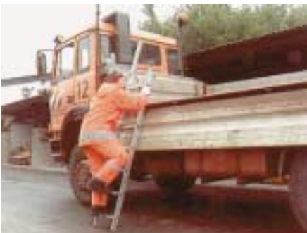
Aluminium-Leiter mit rutschhemmenden Stollen und Holmverlängerung
