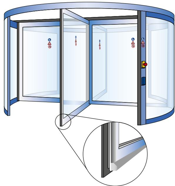
Sicherung von Haupt- und Gegenschließkante erfolgt in der Regel zusätzlich durch Kontaktleisten, die über die gesamte Türhöhe an den Schließkanten angebracht sind.
