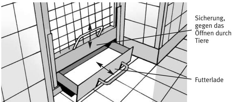
**Bild 19:** Futterlade mit Sicherung gegen das Öffnen durch Tiere
