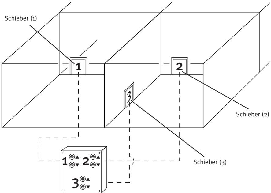
**Bild 7:** Zuordnung der Bedienelemente zu den Schiebern
