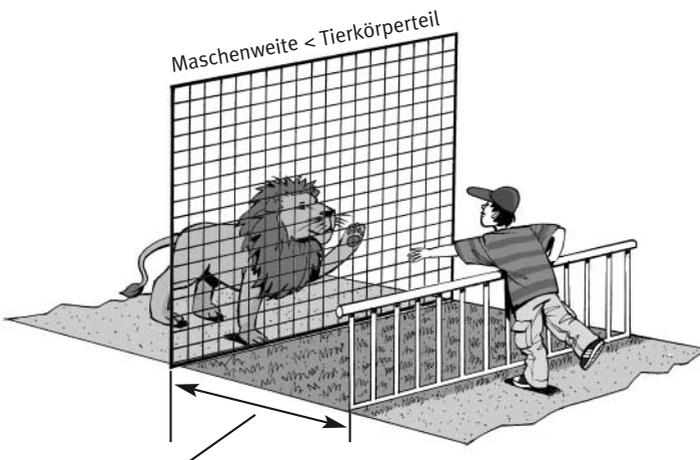
**Bild 21:** Mindestabstand bei einer engmaschigen Gehegeeinfriedung
