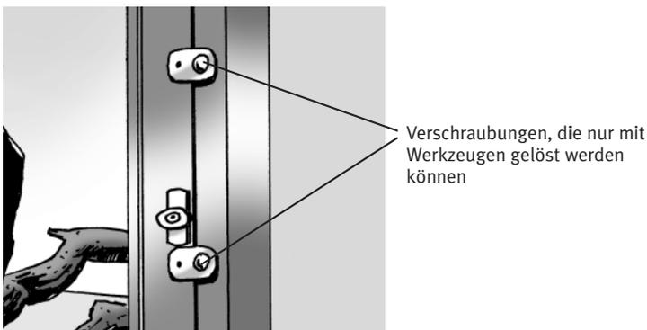
**Bild 18:** Mit Verschraubungen gesicherte Gehegetür ohne Schleuse
