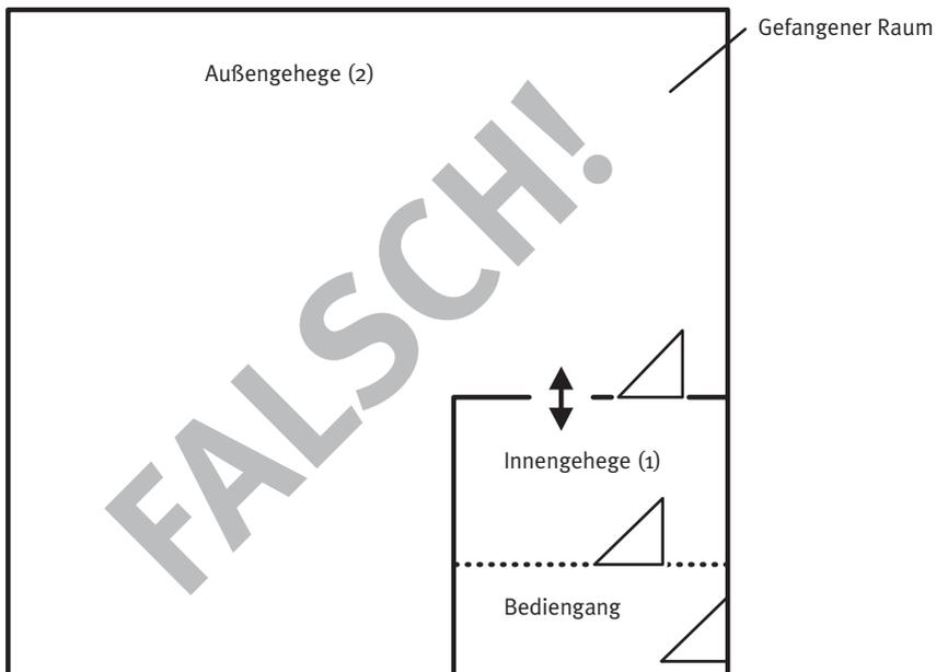
**Bild 2:** Unzulässige Bauform eines Geheges der Sicherheitsstufe II
