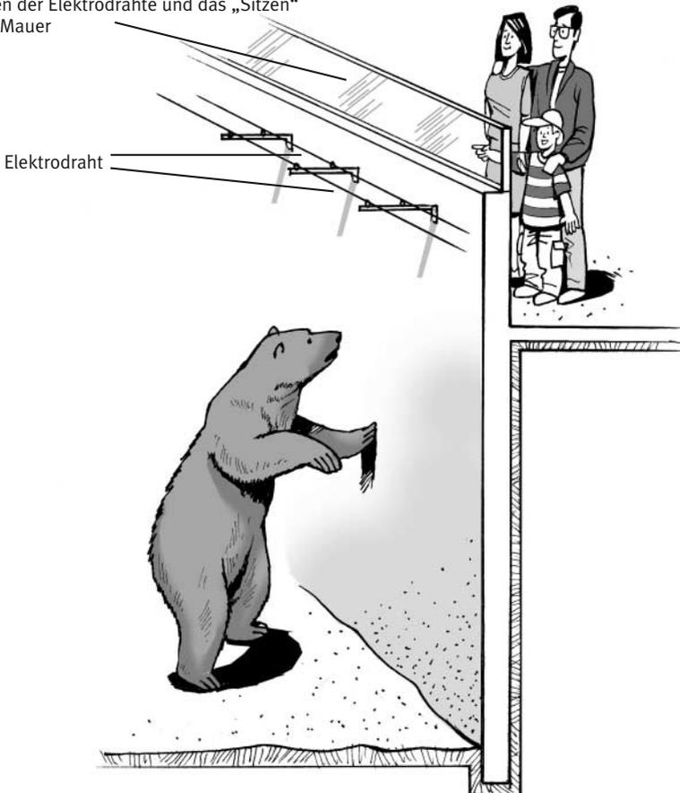
**Bild 26:** Elektrodraht als zusätzliche Sicherung gegen Tierausbruch
