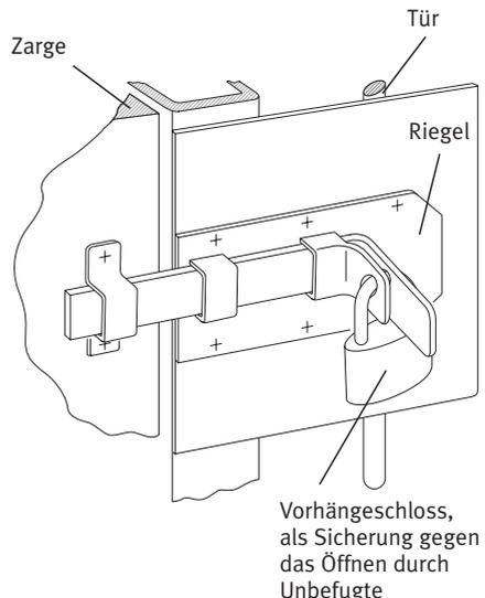
**Bild 15:** Riegel als Türverschluss für gefährliche Tiere
