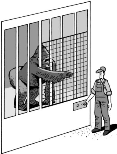
Durch ein engmaschiges Gitter ist die Betätigung des Schiebers gefahrlos möglich. Die Einsehbarkeit in das Gehege bzw. zum Schieber bleibt erhalten.
