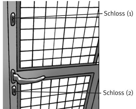
Die Riegeleinrichtungen der Schlösser (1) und (2) sind unabhängig voneinander mit einem Schlüssel zu verschließen bzw. zu öffnen!
