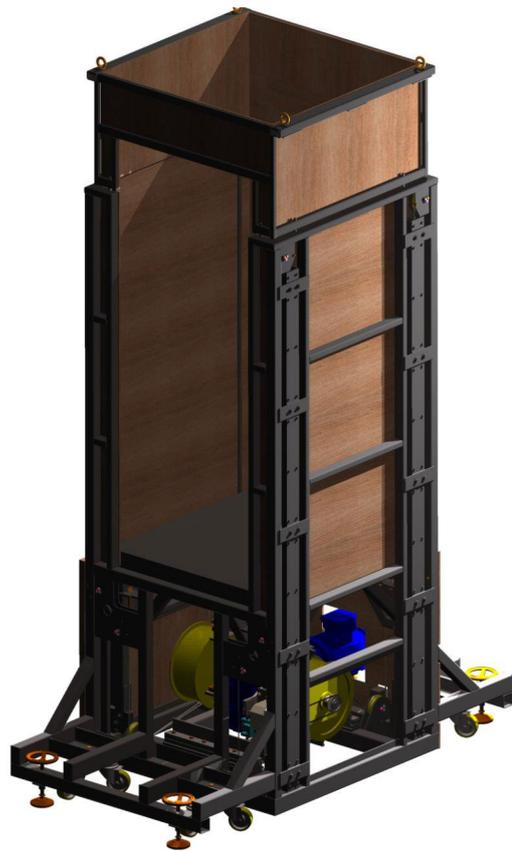
Abb. 2 Schematische Darstellung einer Personenversenkung
