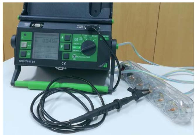
Abb. 6 Durchführung einer Wiederholungsprüfung
