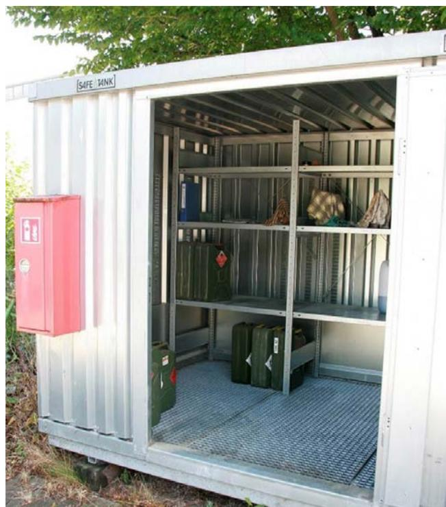
Abb. 8 Vorschriftenkonforme Lagerung von Gefahrstoffen
