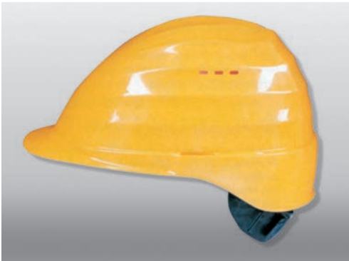
Bild 2: Industrieschutzhelm mit heruntergezogenem Nackenteil, Belüftungsöffnungen und seitlichen Schlitzen zur Befestigung von Zubehör (z.B. Gehörschützer), jedoch ohne Regenrinne
