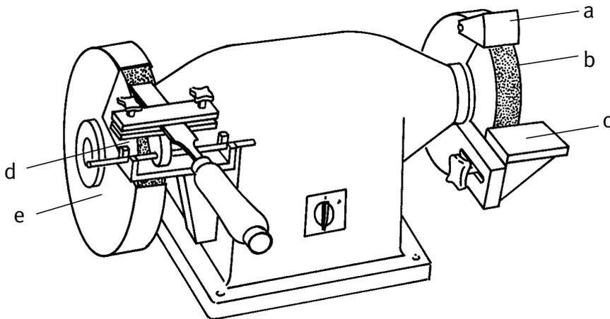
Abb. 33 Schleifmaschine
