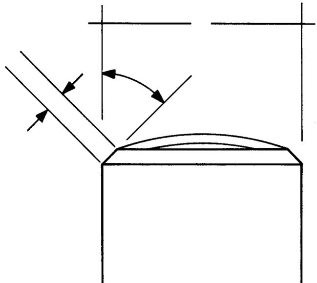
Abb. 4 Richtig angeschliffene Fase an der Bahn
