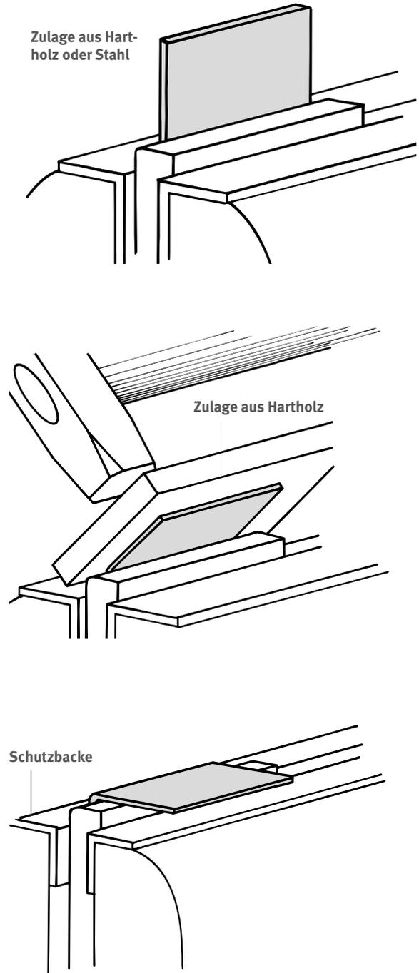
Abb. 10 Scharfkantiges Biegen mit dem Biegeklotz
