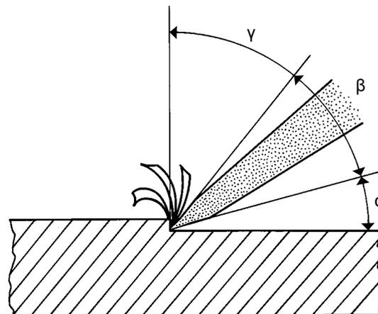
Abb. 21 Abtrennen von Material mit einem Meißel
