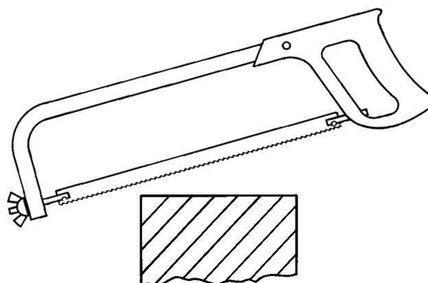
Abb. 17 Ansägen mit der Handbügelsäge
