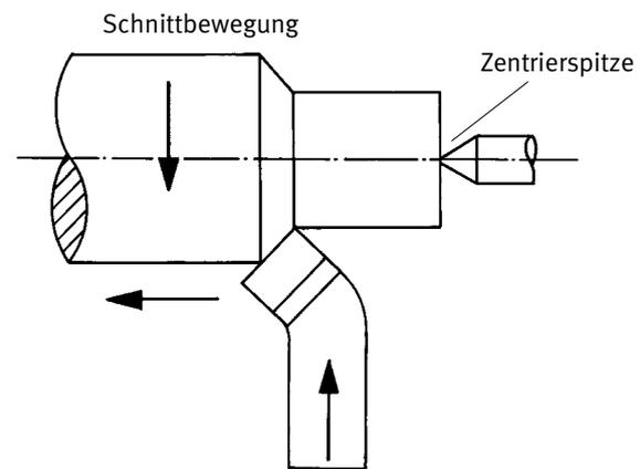
Abb. 30 Langdrehen eines zylindrischen Werkstücks
