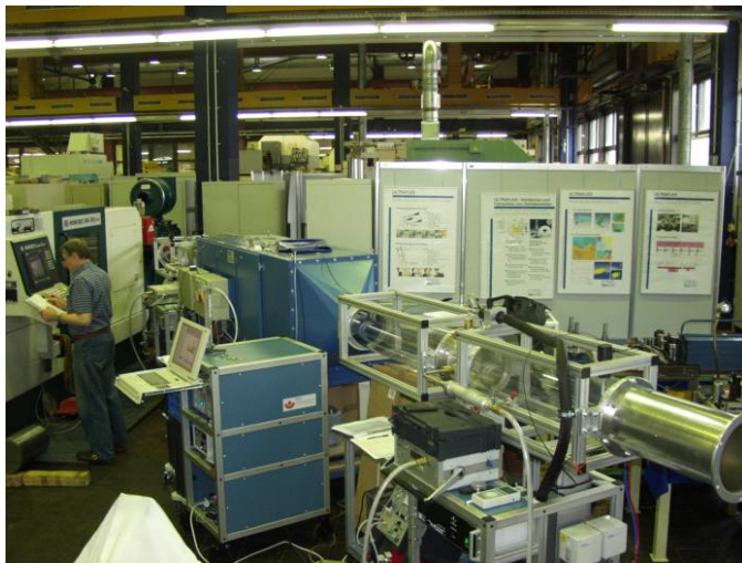
Abbildung 2-12: Prüfstand für Kühlschmierstoffabscheider
