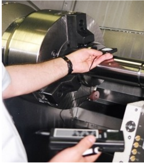
Abbildung 2-38: Überprüfung der Beleuchtung an einer Maschine als Teilaspekt der Ergonomie
