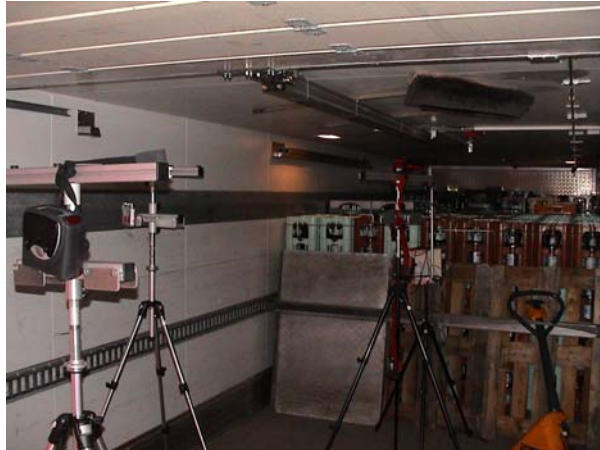
Abbildung 2-13: Sauerstoffmessungen in einem Kühllastwagen
