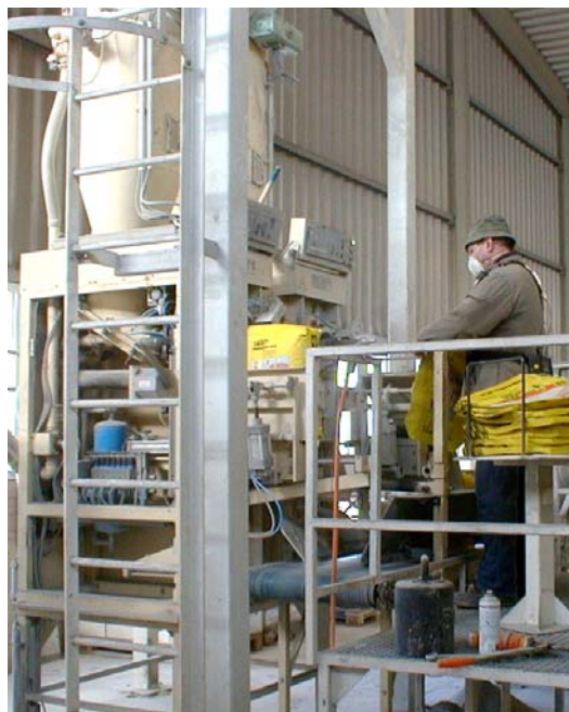
Abbildung 2-11: Messung der Quarzexposition bei der Absackung von Putz
