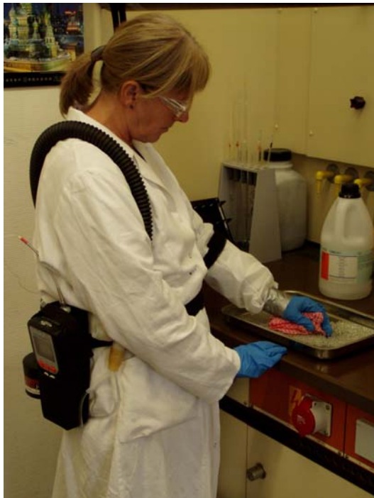
Abbildung 2-34: Durchbruchmessung an Chemikalienschutzhandschuhen
