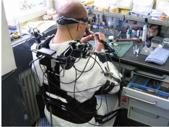
Abbildung 2-30: Erfassung der Schulter-Arm-Belastung an einem Zahntechnikerarbeitsplatz
