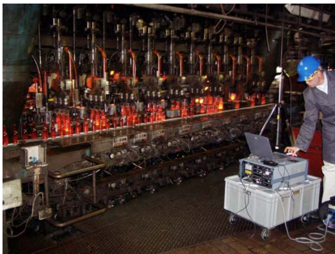
Abbildung 2-28: IR-Strahlungsmessung bei der Flaschenherstellung an einer Hohlglas-Formgebungsmaschine
