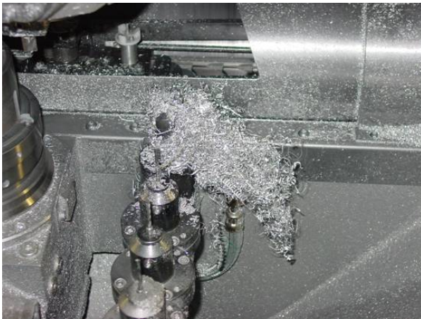
Abbildung 2-24: Späne und Stäube bei der Metallbearbeitung mit Minimalmengenschmierung
