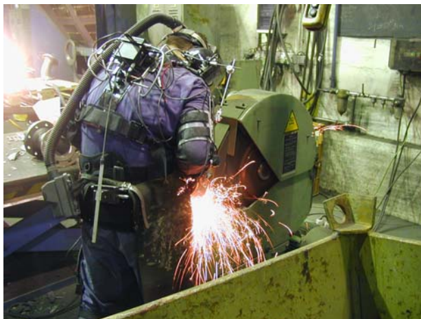
Abbildung 2-33: Belastungsmessung an einem Gussputzerarbeitsplatz
