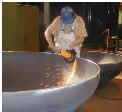
Messung der Hand-Arm-Vibration an einem Winkelschleifer
