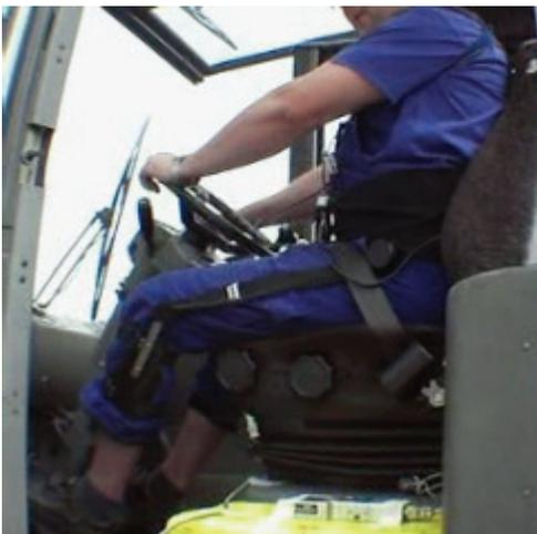
Bestimmung der Kombinationswirkung von ungünstigen Körperhaltungen und gleichzeitigen Ganzkörperschwingungen
