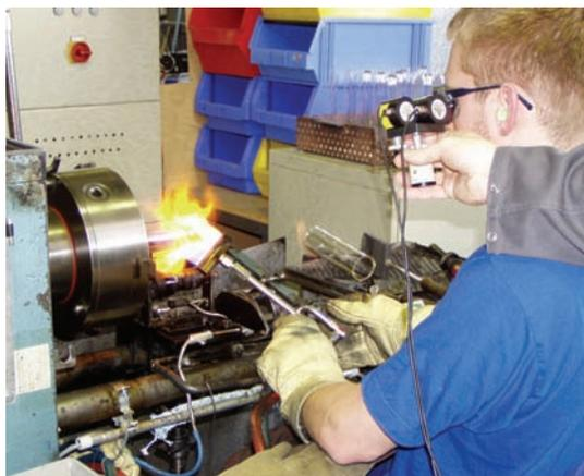
Messung von IR-Strahlung bei der Glasbearbeitung mit einem Handbrenner
