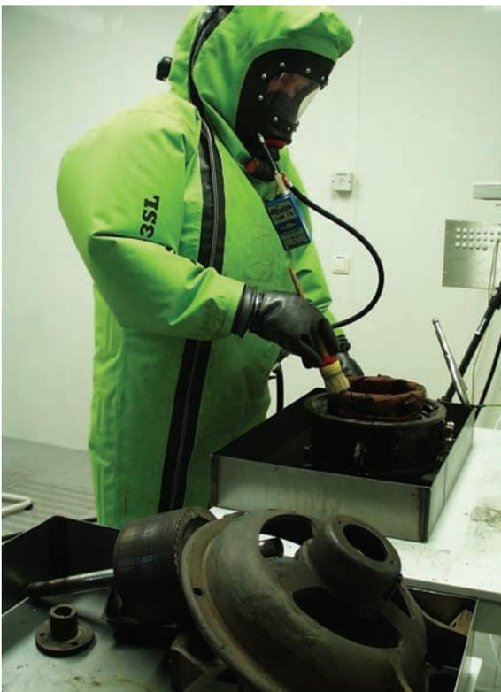
Entfetten von Elektrobauteilen – Proband durch Chemikalienschutzanzug geschützt
