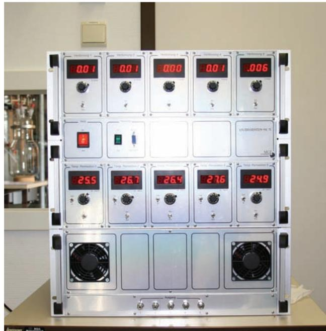
Kapillarverdampfer zur Erzeugung von Prüfgasen
