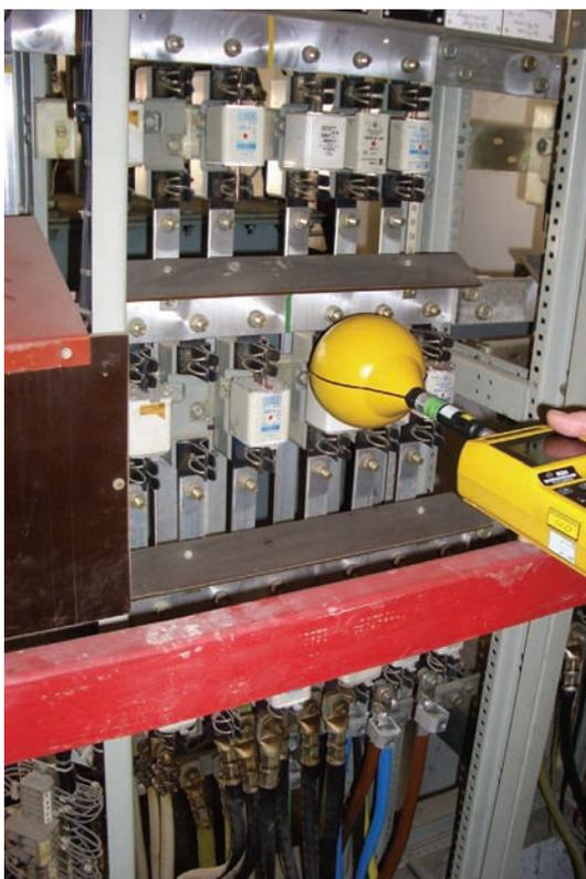
Messung magnetischer Felder an einer Niederspannungsunterverteilung
