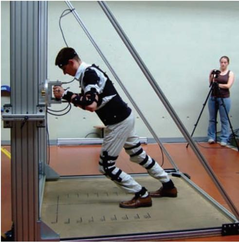
Messungen der Hand-Arm-Kräfte und der Körperhaltung bei real-typischen Arbeitshaltungen im Rahmen des Kraftatlas-Projekts
