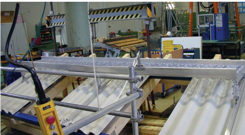
Prüfung eines Begehungssystems für Dächer
