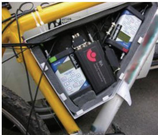
Vibrationsmesssystem an einem Fahrradrahmen
