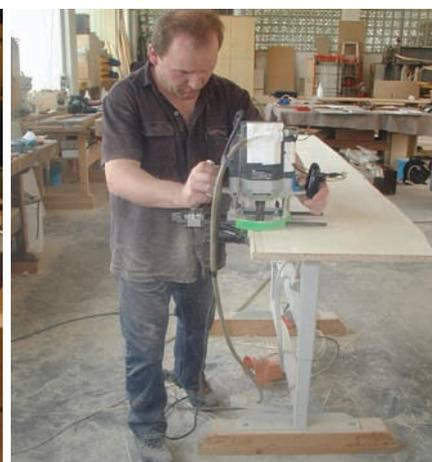
Messung der Hand-Arm-Vibration an einer Oberfräse
