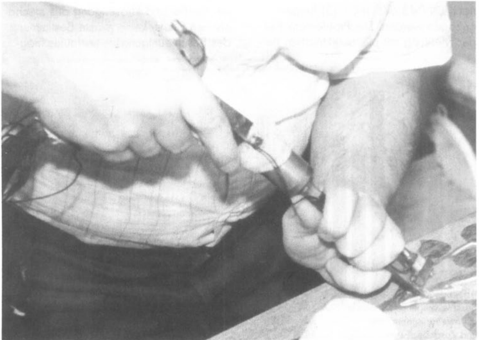
Abbildung 1: Typische Handhabung eines Meißelhammers mit Meißel
