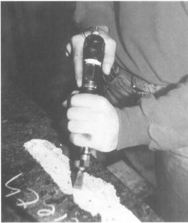
Abbildung und Spektrum des untersuchten Meißelhammers Lfd. Nr. 7 Deprag, Typ ZN 23 K
