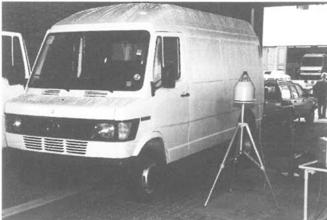
Abb. 2: Beschallung des Fahrzeugführerhauses mit der Testschallquelle bei der Messung der Schalldämmung
