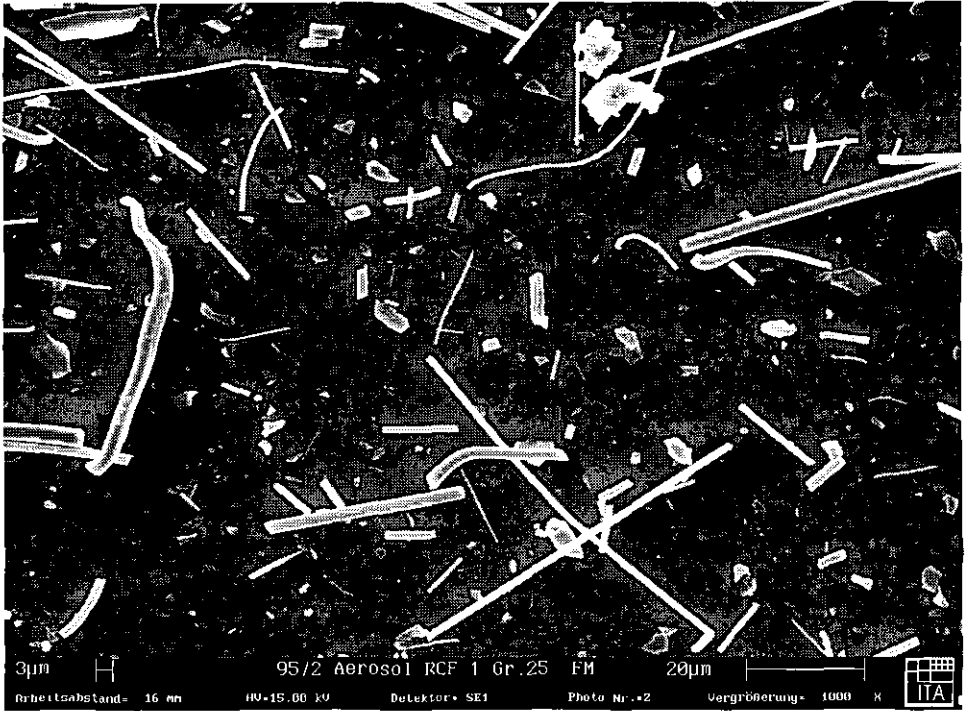
Keramikfaser RCF 1 (Aerosolprobe aus Inhalationsversuch)
