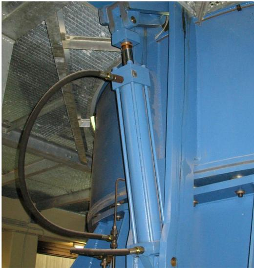
**Bild 1:** Leistungselement *Zylinder* an einer Prüfmaschine
