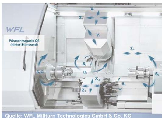
**Bild 1:** Achsschema einer Werkzeugmaschine
