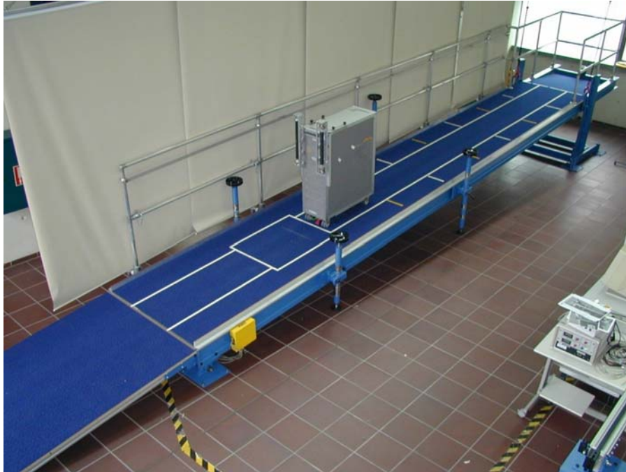
Abbildung 5-3: Nachgebildeter geneigter Flugzeugboden mit Fullsize-Trolley
