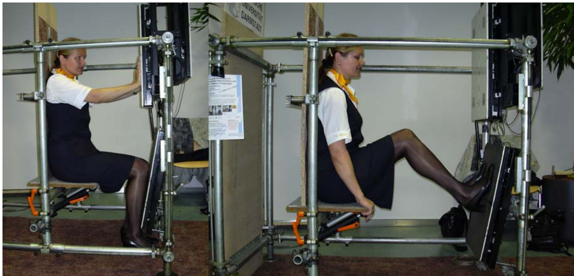
Abbildung 4-31: Messung der Arm- und Beinkräfte im Kraftmessgestell
