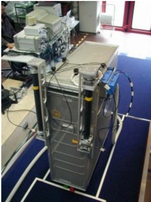
Abbildung 5-8: Adaptiertes Handkraftmesssystem mit Verkabelung und Messstation
