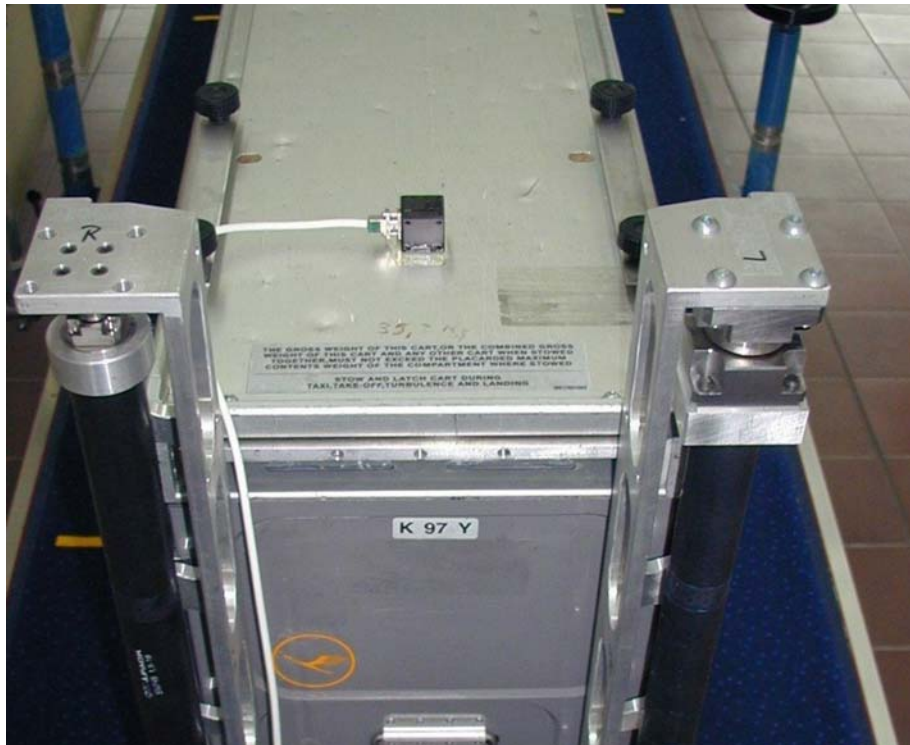
Abbildung 5-11: Adaptierter dreiaxialer Beschleunigungssensor am Fullsize-Trolley
