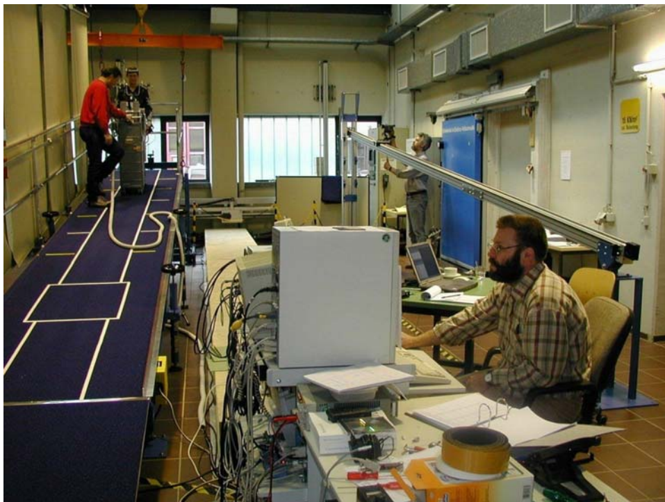
Abbildung 5-1: Prüffeld mit Einrichtungen zur Durchführung der Schiebe- oder Ziehversuche
