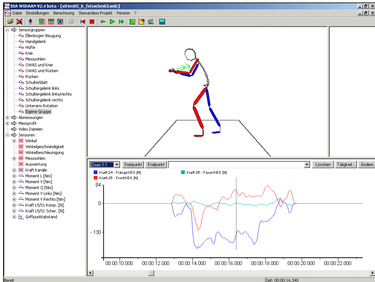
Abbildung 5-16: Bildschirmansicht der Auswertungssoftware des CUELA-Messsystems. Die grünen Pfeile stellen die Reaktionskräfte eines Trolleys beim Schieben dar.
