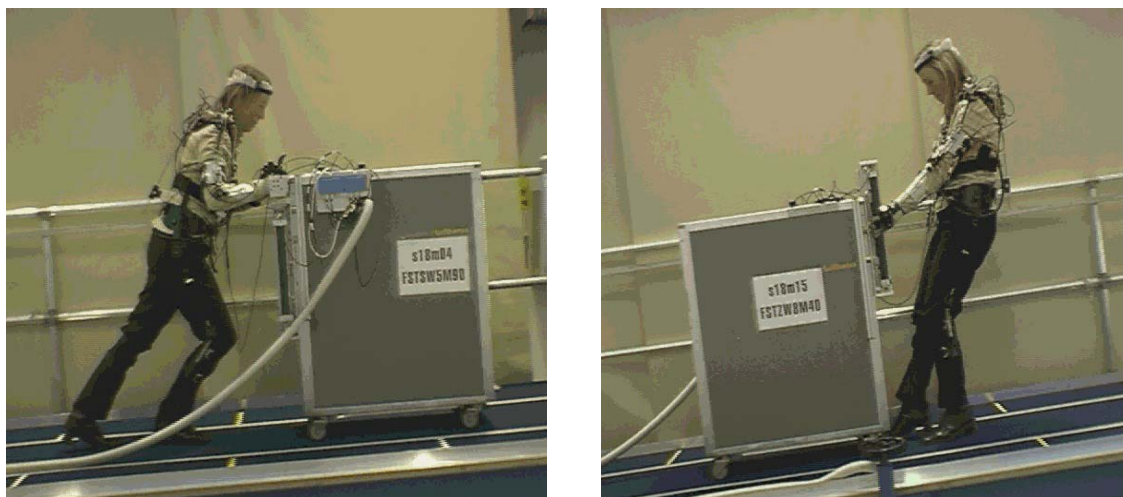
Abbildung 4-7: Probandin beim Schieben und Ziehen des Trolleys über eine schiefe Ebene (Laboruntersuchungen des BIA 2002)
