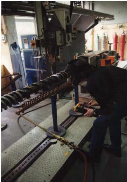
Abbildung 2: Prozessbeobachtung und Optimierung beim Auftragschweißen mit Robotern
