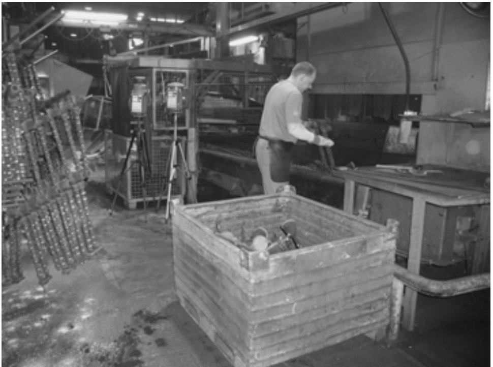
Abbildung 38: Ausleeren der Formkästen nach dem Abgießen
