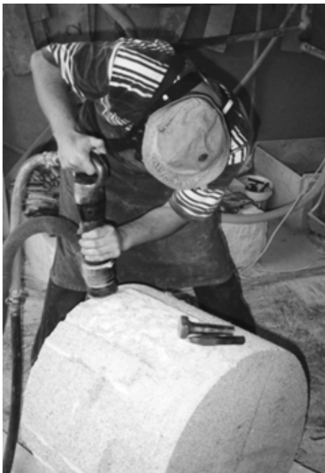
Abbildung 19: Manuelle Bearbeitung an Naturwerksteinen: Stocken
