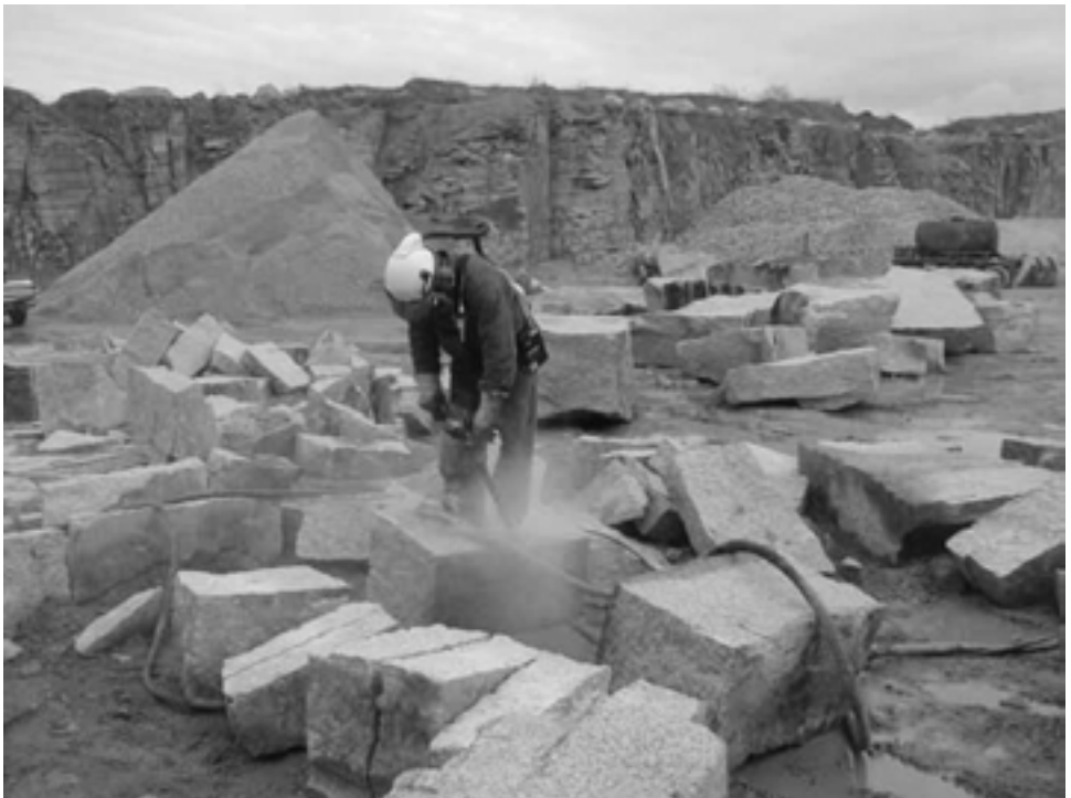
Abbildung 21: Spalten von Natursteinen mit einem Drucklufthammer
