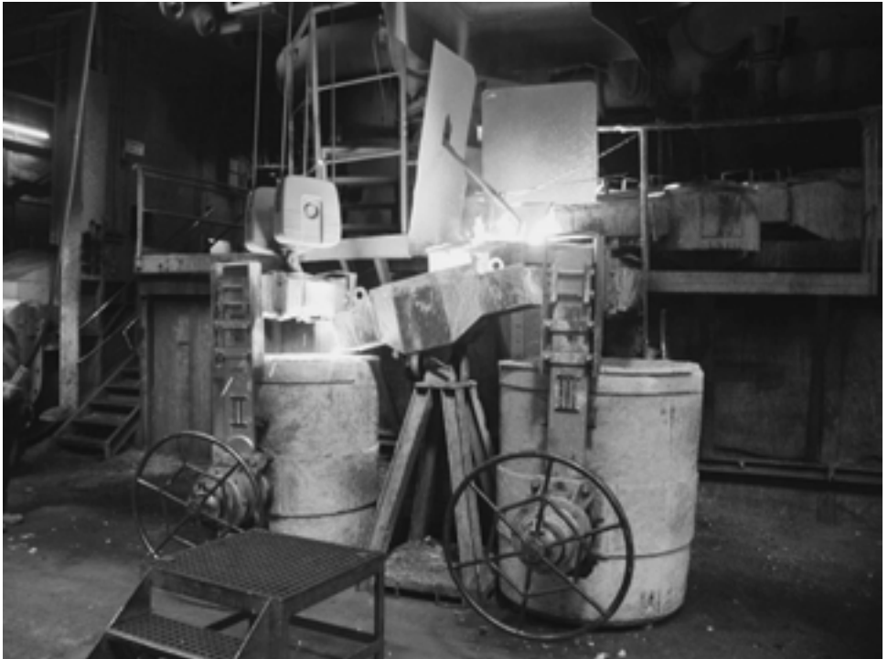
Abbildung 39: Flüssiges Metall wird in die Gießpfanne überführt
