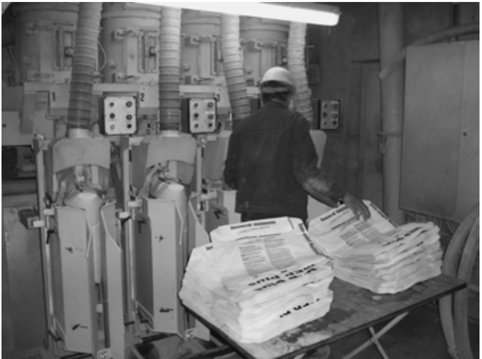
Abbildung 29: Absackung von Edelputz
