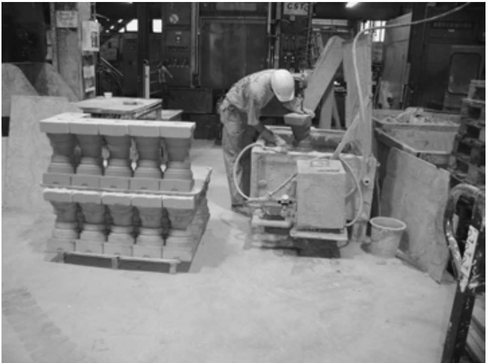
Abbildung 37: Tauchen der fertigen Kerne in Schlichtelösung
