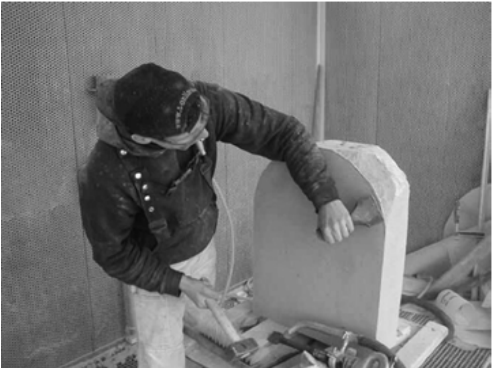
Abbildung 18: Manuelle Bearbeitung von Naturwerksteinen: Bossieren
