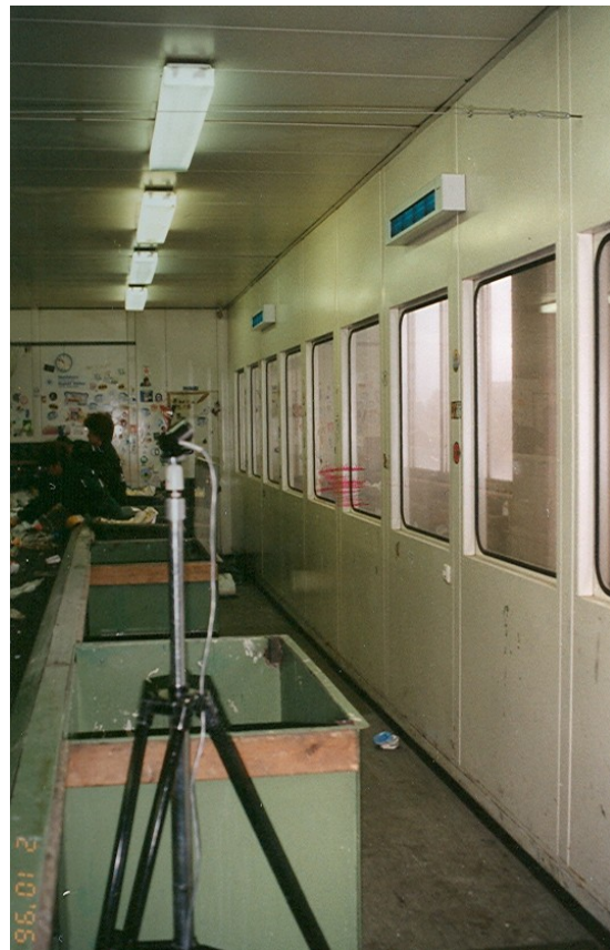
Abbildung 13: UV-Entkeimungslampe in der Nähe des Förderbands einer Wertstoffsortieranlage
