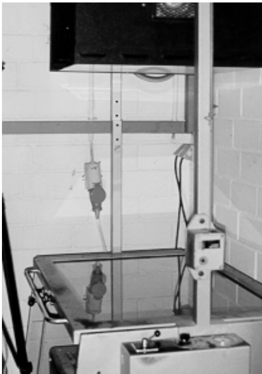
Abbildung 8: Belichtungsgerät älterer Bauart mit offenem Strahlengang
