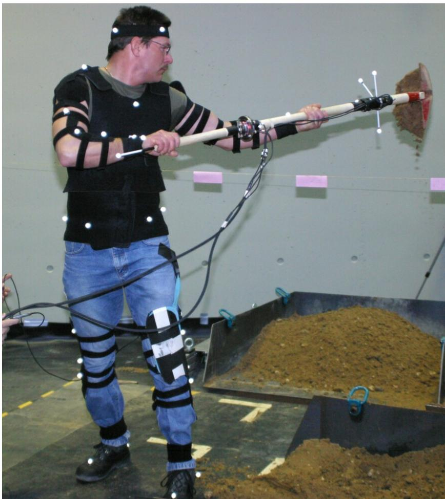
Im VICON-System wurde ein biomechanisches Menschmodell des Muskel-Skelett-Systems implementiert, das die kinematischen Messgrößen als Eingangsdaten nutzte. Dieses umfasste 15 Segmente, bestehend aus jeweils dreigliedrigen Extremitäten und Rumpf (Becken, Brustkorb und Kopf) (Abbildung 2.8). Die Schaufel wurde als ein eigenständiges dreidimensionales Objekt erfasst.
