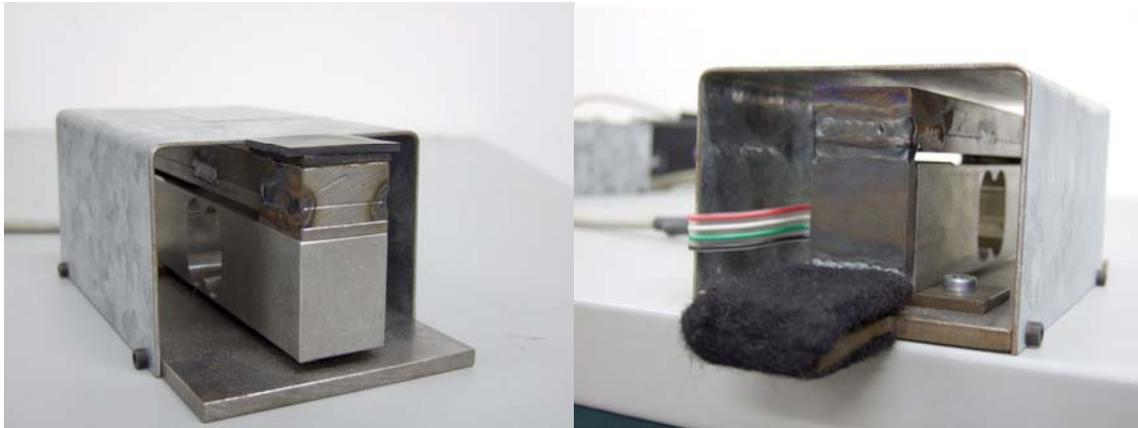
Schließlich war es zum Messen der Greifkraft an der Kombizange (Greifweite 65 mm) nötig, einen möglichst kleinen zwischen die Zangenschenkel passenden Aufnehmer zu finden. Hierzu nutzten wir einen Piezo-Mehrkomponenten-Kraftsensor der Fa. Kistler Typ 9117A 1,5 mit lediglich 10 mm Bauhöhe bei einem Durchmesser von 25 mm, der zwischen zwei Halteschienen in vorgespanntem Zustand mit der Zange in der Hand des Probanden Platz findet (Abbildung 2.35).
