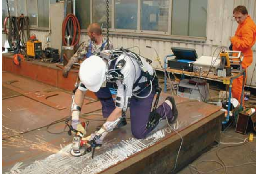
Forschung am Institut für Arbeitsschutz: Sensoren messen die Vibrationsbelastung und Körperhaltungen an einem Schleifarbeitsplatz, um Belastungen des Muskel-Skelett-Systems durch manuelle Lastenhandhabung, ungünstige Körperhaltungen oder repetitive Bewegungsabläufe zu erkennen.
