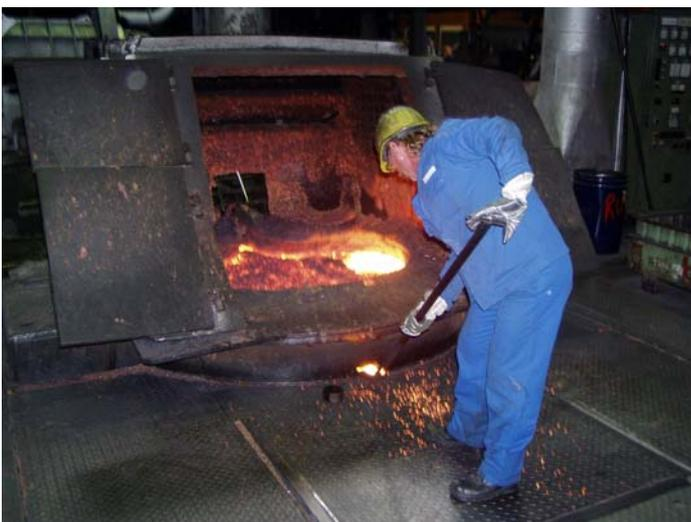
Bild 1: Exposition durch Wärmestrahlung an einem Metallschmelzofen
